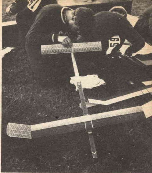
Un interessante Wakefield dell'aeromodellista russo Kolpakov, con profilo sottilissimo e struttura geodetica a triplo incrocio. L'ala è del tipo plurilongherone, mentre il piano orizzontale ha un solo longherone centrale.
